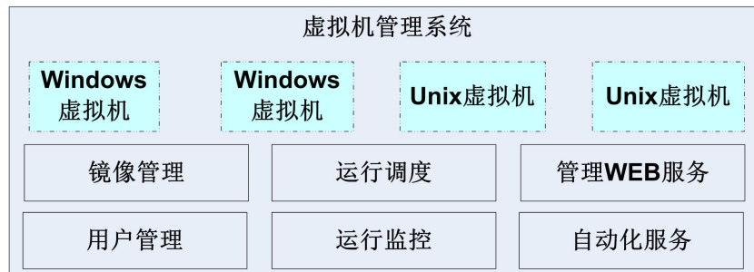
图 4-6 数字有机体系统的虚拟机管理系统的框架
