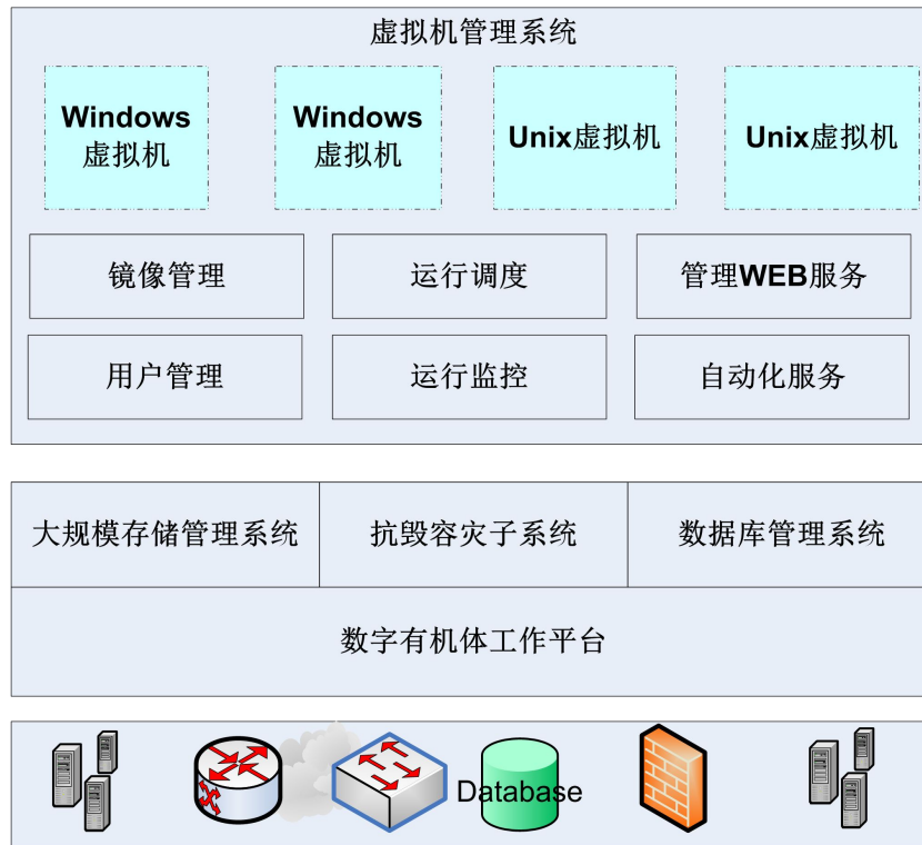
图 4-8 虚拟机运行模式的逻辑结构
