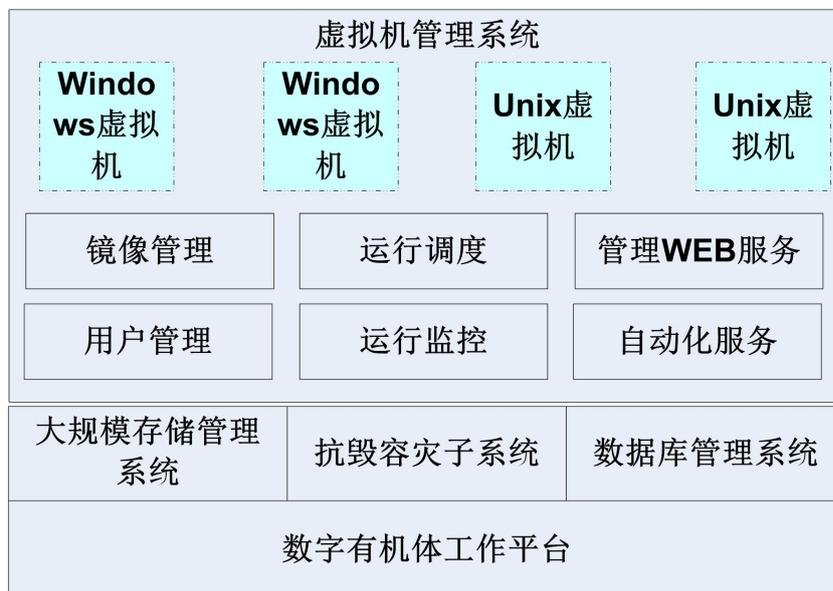
图5-2 虚拟机管理系统的框架
