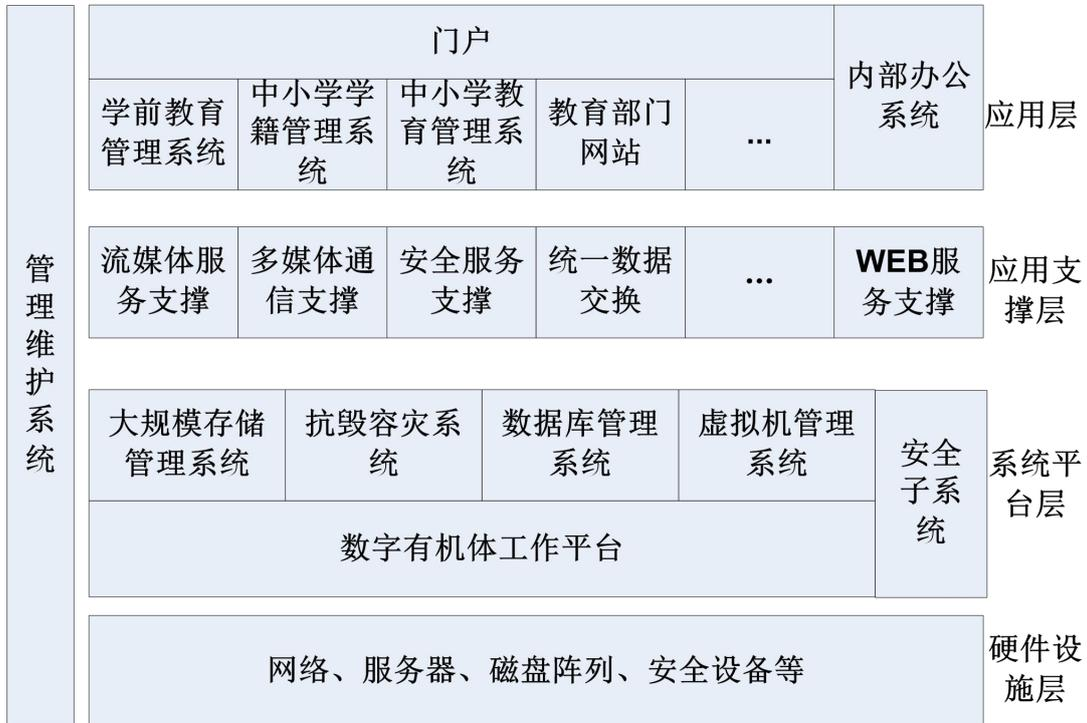
图 6-3 系统软件层次结构
