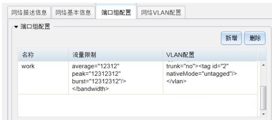
图 10- 60：新增 OVS 桥接网络之端口组配置
