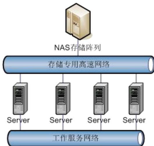
图 3- 2：NAS 存储虚拟化的部署示例
