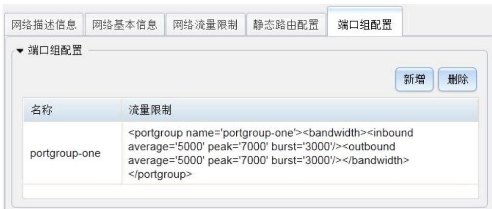
图 10- 35: 新增隔绝网络之端口组配置
