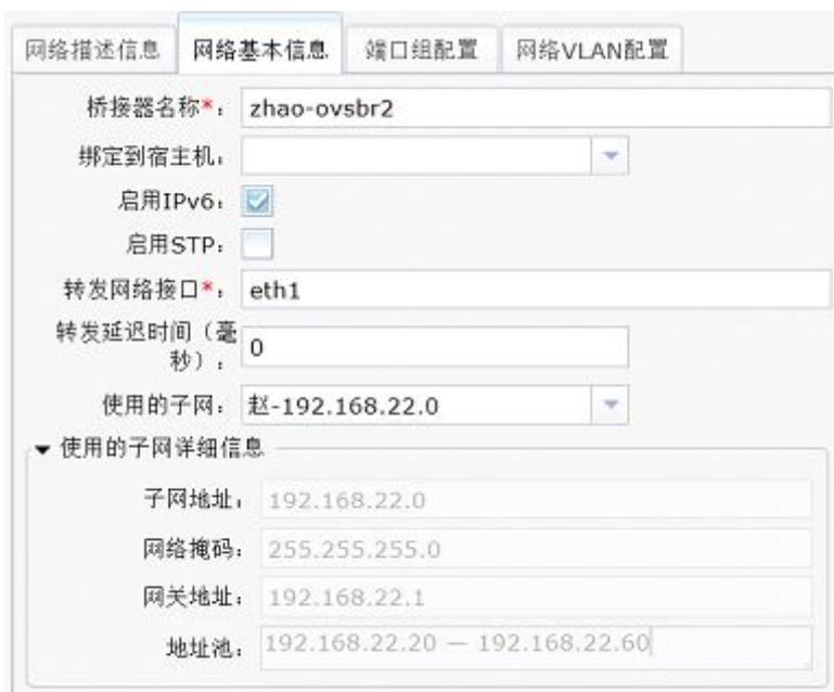
图 10- 59：新增 OVS 桥接网络之网络基本信息
